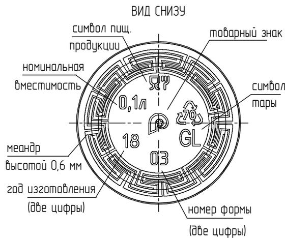
Допускается минимальная толщина стенки 0,8мм толщина дна 2,0мм
